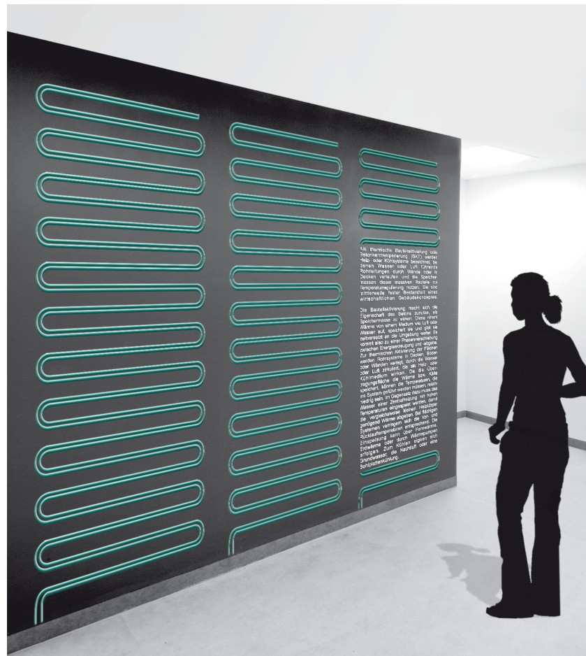
Abb. 57 Ornamentale Muster stellen die Rohregister zur thermischen Bauteilaktivierung dar
