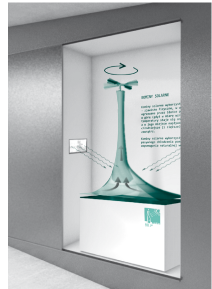
Abb. 42 Modell eines Solarkamins veranschaulicht den Kamineffekt.
