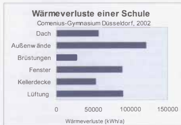
Abb. 6: Wärmeverluste einer Schule
